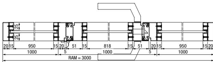
Horizontalschnitt 1-flügelige Stahl-Lofttür mit Seitenteilen und Oberlicht
